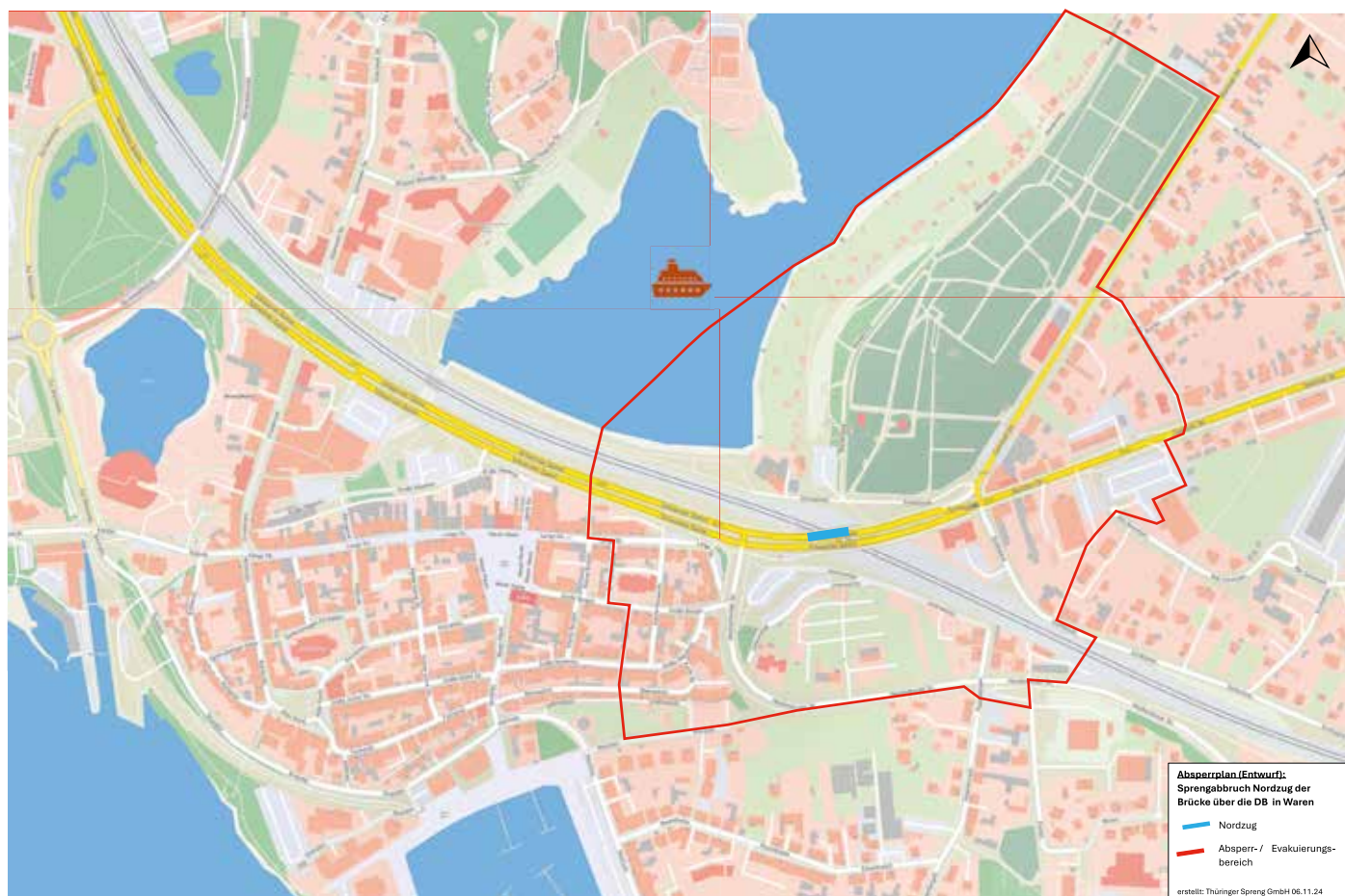
Absperrplan (Entwurf): Sprengabbruch Nordzug der Brücke über die DB in Waren; erstellt: Thüringer Spreng GmbH 06.11.24
